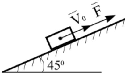
Материальной точке массой  $m = 20$  кг сообщена начальная скорость  $V_0 = 10$  м/с. На точку действует сила  $F = 3 \cdot t^2$  Н. Трение отсутствует. Определить скорость точки в момент времени  $t = 10$  с (принять  $g = 10$  м/с<sup>2</sup>).
