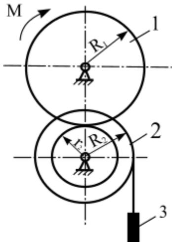
Механизм под действием пары сил с моментом  $M = 1,6$  кН·м приходит в движение из состояния покоя. Задано:  $m_1 = 80$  кг;  $m_2 = 240$  кг;  $m_3 = 30$  кг;  $R_1 = 1$  м;  $R_2 = 5$  м;  $r_2 = 2,5$  м; звено 1 – однородный диск, звено 2 – ступенчатый диск с радиусом инерции  $i_2 = 2,5$  м. Определить ускорение груза 3 (принять  $g = 10$  м/с<sup>2</sup>).
